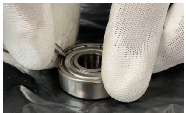
Entfernung der ZZ-Dichtung
